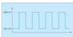
Цикл работы традиционного чиллера большой мощности
